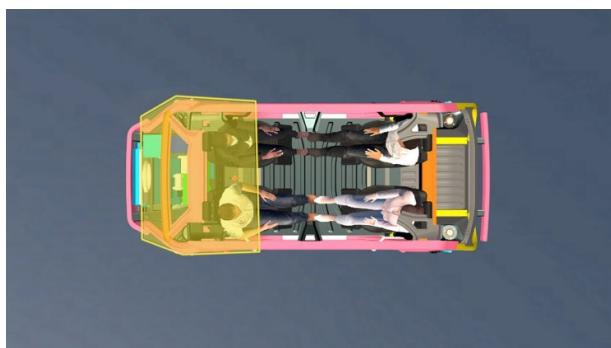
**Didascalia dell'immagine:** La zona di protezione passeggeri estesa in acciaio AHSS difende al meglio i passeggeri da eventuali intrusioni, riducendo il rischio di lesioni. Lo stampaggio a caldo dell'acciaio permette di ottenere geometrie complesse, rese più resistenti dall'acciaio martensitico.
